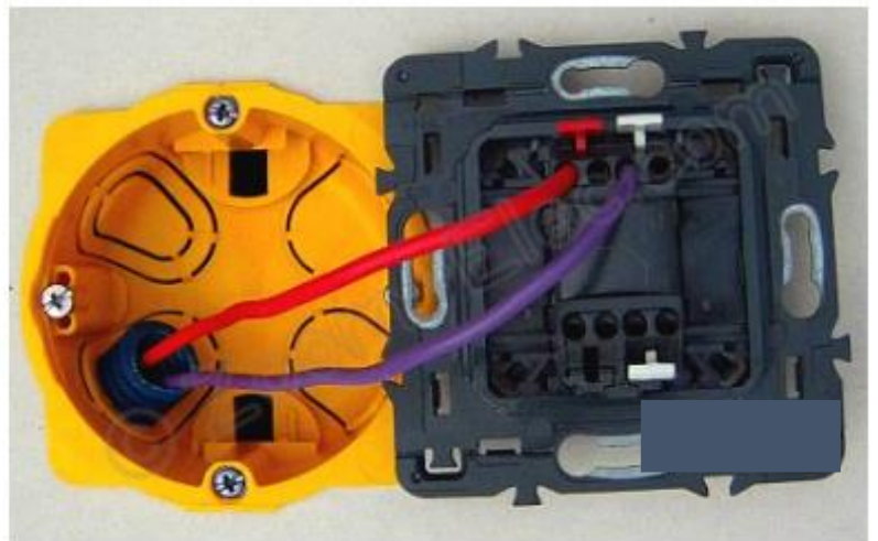
Branchement d'un interrupteur Legrand Céliane ou Mosaic :
